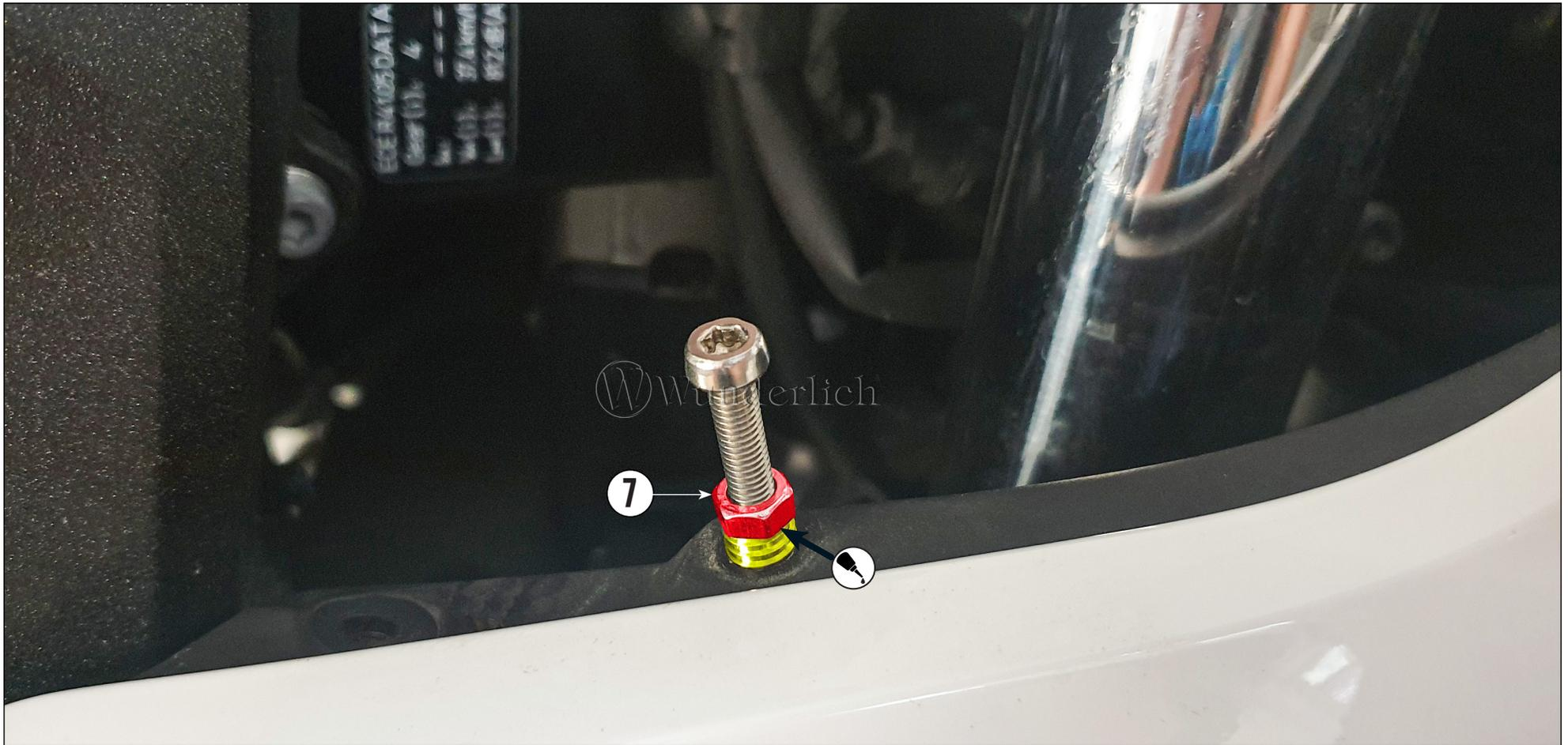
**DIE VON BMW EINGESETZTEN GEWINDEHÜLSEN (GELB MARKIERT) KÖNNEN SICH BEI DER DEMONTAGE LÖSEN. MIT DIESEM SCHRAUBER-TIPP BEKOMMEN SIE DIE GEWINDEHÜLSEN WIEDER AN IHREN PLATZ. DREHEN SIE DIE MITGELIEFERTE SECHSKANTMUTTER MIT DER GEWINDEHÜLSE 4-5MM WEIT AUF EINE PASSENDE SCHRAUBE UND KONTERN DIE GEWINDEHÜLSE MIT DER MUTTER. BEVOR SIE DAS GANZE JETZT BIS ZUR MUTTER EINDREHEN, GEBEN SIE ETWAS SCHRAUBENSICHERUNG (NUR) AN DAS ÄUßERE GEWINDE DER HÜLSE. SECHSKANT-MUTTER SOWIE SCHRAUBE LÖSEN UND FERTIG.**
